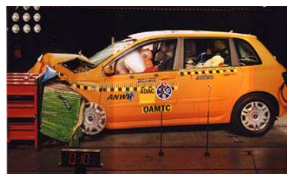
Offset-Crashtest auf einer kombinierten Crashtest- und servo-hydraulischen Schlittenanlage (ADAC, Landsberg)
