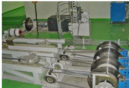
Modulmäßig erweiterbarer Anlagenantrieb für unterschiedliche Bahnen und Geschwindigkeiten (Hyundai, Südkorea)
