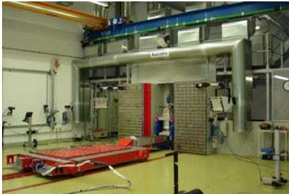
Servo-hydraulische Verzögerungs-Schlittenanlage im Block versenkt (Autoliv, Dachau)
